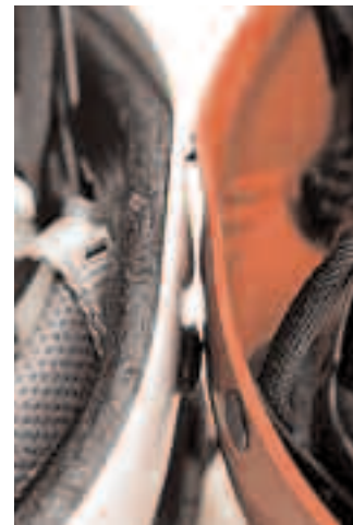
Das seitliche Stoßdämpfungsvermögen ist beim linken Helm deutlich besser als beim rechten
