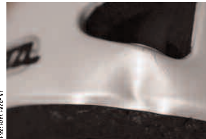
Druckschaden an einem Inmoldinghelm, nachdem dieser im Rucksack verstaut war und sich jemand darauf gesetzt hatte
